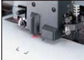
El indicador de luz ajusta fácilmente la posición del cabezal para recortar las marcas.
