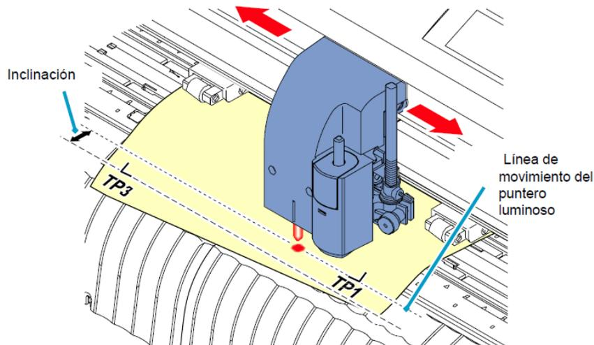
Colocación del sensor para detectar marcas
