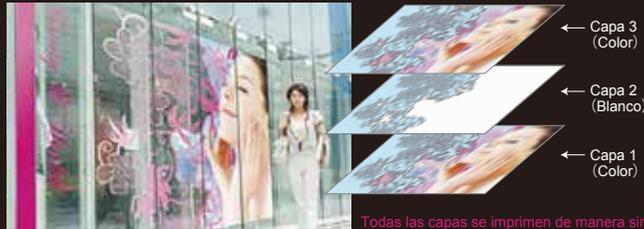
Todas las capas se imprimen de manera simultánea
